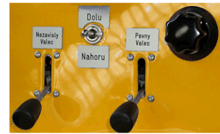
Zwei Einachssteuerknüppel mit Drehregler für Hydraulische Proportional-Steuerung.
